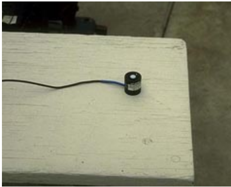
Figure 9. PAR meter for measuring instantaneous PAR and calculating DLI.
